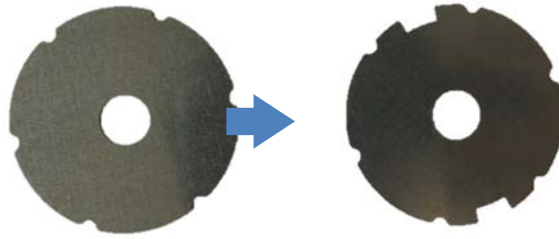
図3 入力円板の外観（左：旧試作機，右：新試作機）
