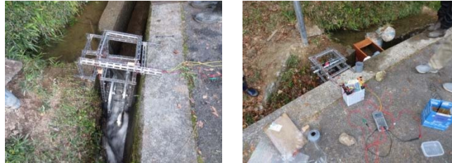
写真 左：テスト中の水車風景、右：バッテリーを充電状況測定風景
