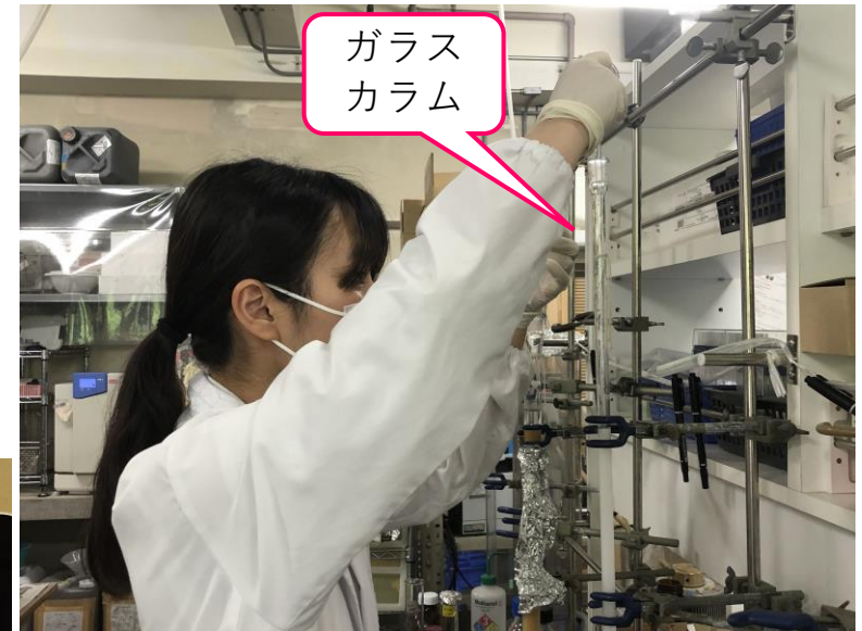
ガラスカラムにクロマトグラフィー用ゲルを充填している様子
